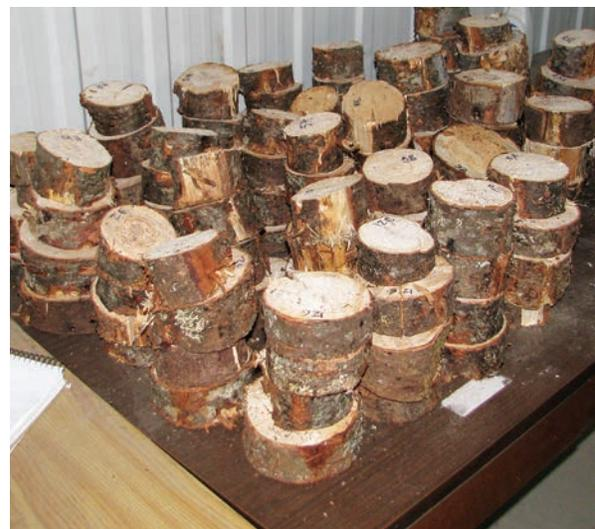
Disques échantillons pour déterminer le taux d'humidité initial en janvier 2012
