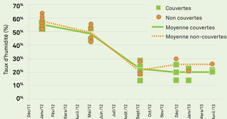
Figure 3. Courbe de séchage naturel pour les piles couvertes et non couvertes (contrôles)
