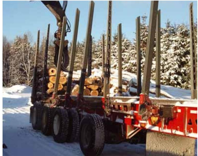
Sur ce prototype, une partie des poteaux et des traverses est en acier et l'autre en matériaux composites. L'objectif était d'être en mesure de comparer sur une même semi-remorque l'acier et les matériaux composites. Cette remorque a été soumise à 6 mois d'essais en opération, majoritairement dans des conditions sévères (hors route); le système en matériaux composites a performé avec brio.
