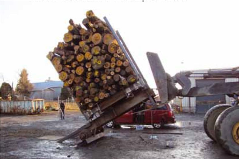
Tests des poteaux et des traverses dans la cour de Deloupe en Beauce. Une batterie de tests a été effectuée sur les éléments en matériaux composites et leur assemblage avant que la semi-remorque destinée aux tests ne soit livrée à une entreprise de la Beauce pour des essais routiers.
