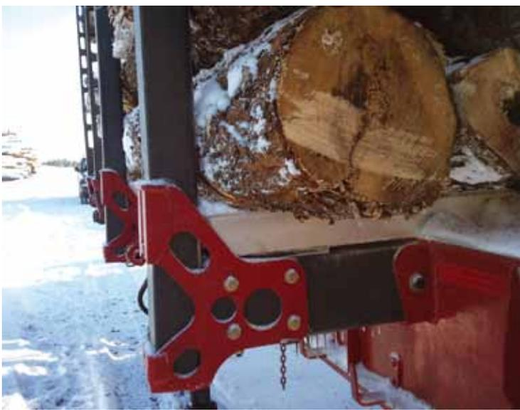
Les composantes en matériaux composites nécessitent une adaptation de la part des concepteurs. Ils doivent trouver la meilleure façon de joindre les poteaux aux traverses : ils ne sont pas soudés, mais boulonnés aux boîtes. La forme des boîtes évolue de façon à répartir davantage la contrainte sur l'ensemble du poteau, sans pour autant influencer les caractéristiques prescrites pour ces semi-remorques.
