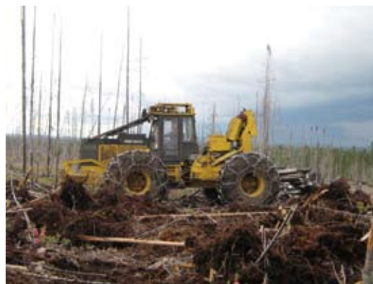
Figure 4. Scarificateur à disques motorisés TTS-Delta installé sur un débardeur John Deere 748E
