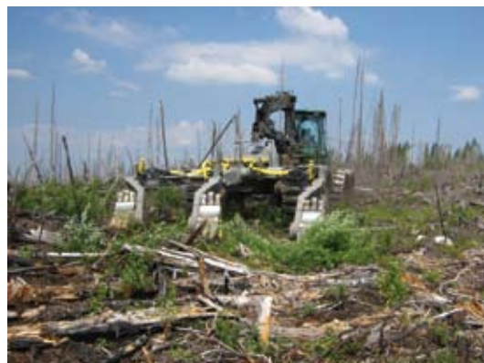
Figure 2. (à droite) Roues de scarifiage du Bräcke M36a munies de trois séries de trois dents défonceuses.
