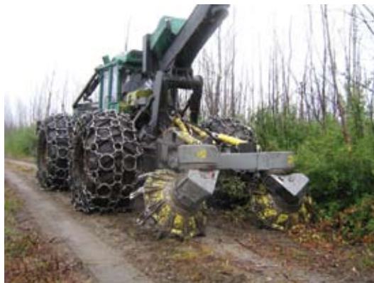
Figure 3. Scarificateur à disques motorisés Bräcke T26a installé sur un débardeur John Deere 748G.
