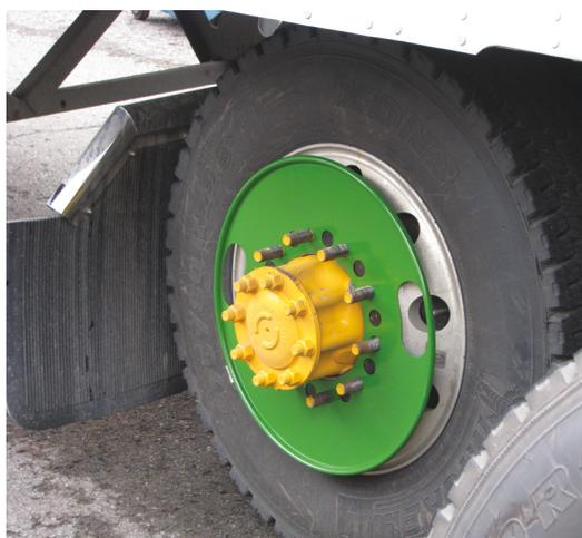
Figure 3. Systèmes autoréglables d'équilibrage de roues
