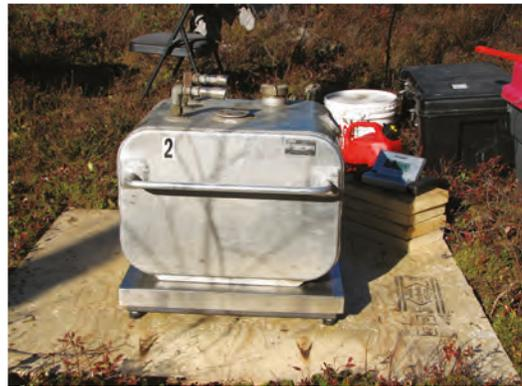
Figure 5. Réservoir amovible installé sur la balance pour le mesurage
