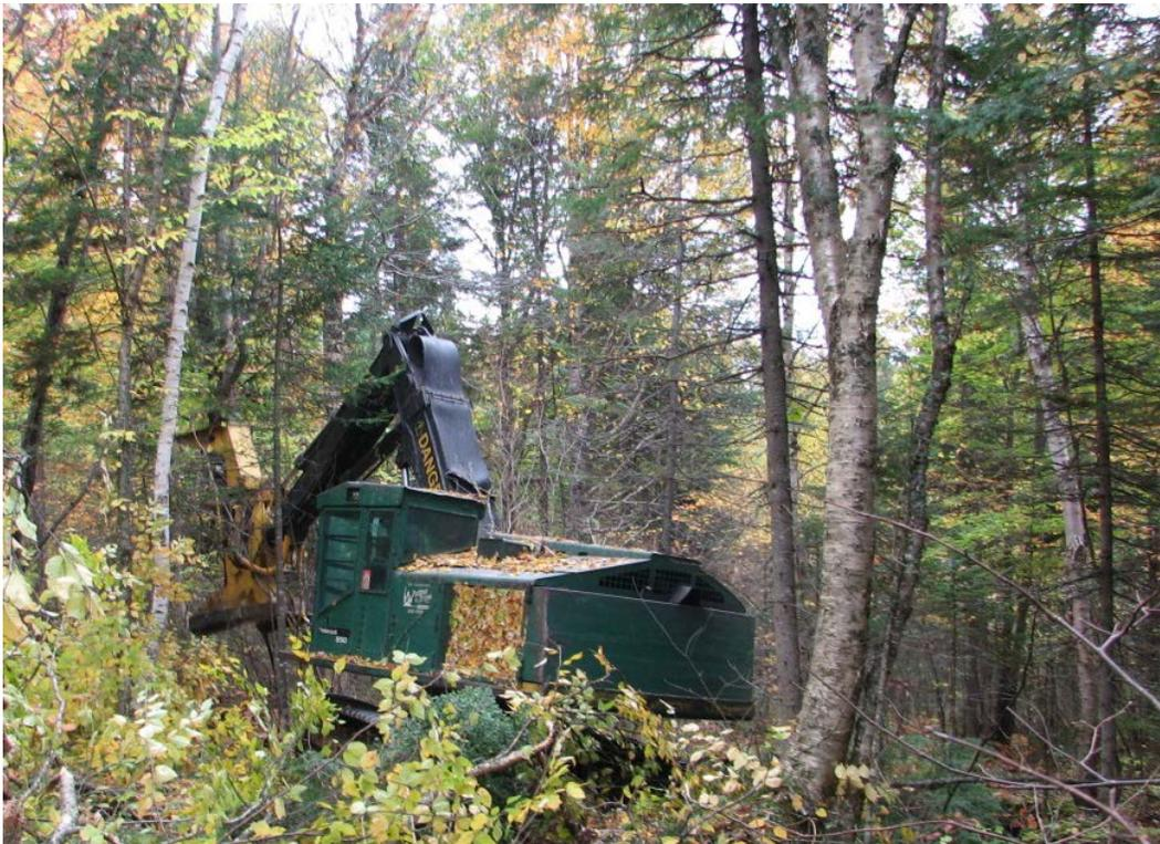
**Figure 1. Autour de l'abatteuse-groupeuse, l'opérateur doit choisir rapidement parmi les quelques arbres à sa portée, celui qui s'approche le plus de l'intention sylvicole**
