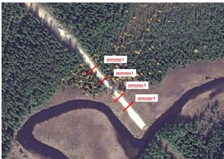
**Figure 2. Vue aérienne de la route construite et de l'emplacement des ponceaux.**
