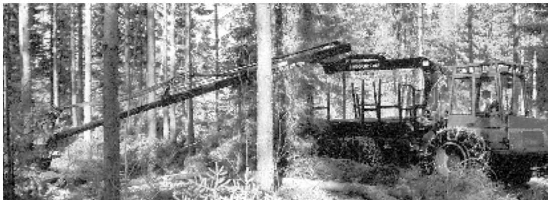
Figure 13. Un porteur muni d'une longue flèche peut réduire les besoins d'empilage manuel par les bûcherons qui abattent et façonnent les billes.
