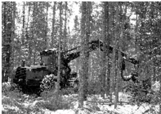
Figure 10. Une abatteuse-façonneuse de grosses dimensions qui travaille habituellement en coupe totale, comme le Timberjack 1270, peut être utilisée pour des travaux d'éclaircie, évitant le recours à de l'équipement spécialisé. Une éclaircie de peuplements à proximité d'un chantier de coupe totale peut alors être envisagée.
