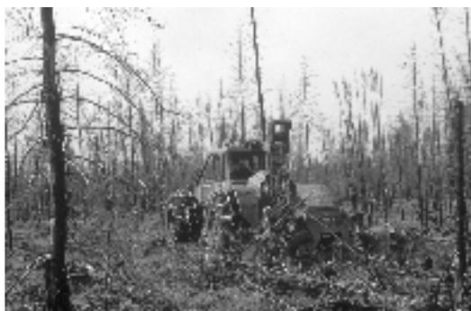
Figure 3. (à gauche) Abatteuse-groupeuse avec tête à pleine inclinaison latérale utilisée pour le nettoyage et la mise en andains de peuplements brûlés.
