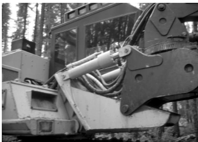
Figure 2. Assemblage du pivot de la base de la flèche.
