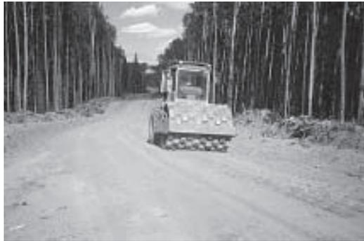
Figure 6. Compacteur vibrant à pieds de mouton utilisé sur la route d'essai.
