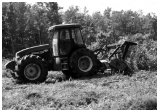
Figure 1. Broyeur FAE UMM/S-225 monté sur un tracteur New Holland Versatile TV140.
