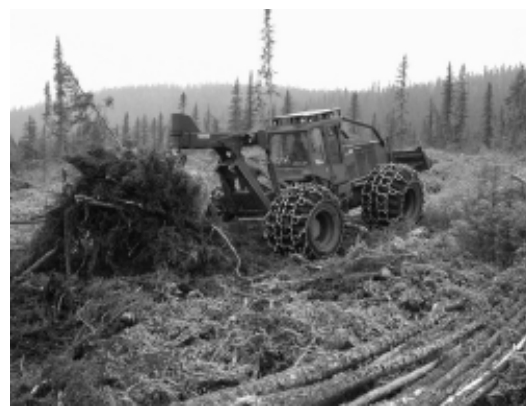
Figure 1. Débardeur à grappin transportant des résidus d'ébranchage.
