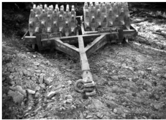
Figure 2. Compacteur tracté de 6 t à pieds de mouton utilisé sur la route à surélévation.
