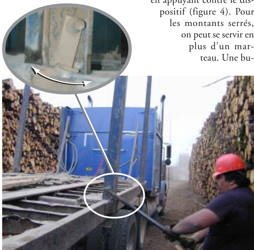
Figure 4. (en bas) Utilisation du dispositif à levier développé par FERIC. (En haut) La butée d'arrêt.
