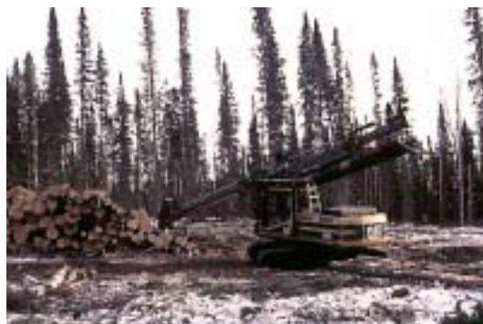
Figure 17. Ébrancheuse à mât coulissant au travail sur une jetée Cdom .
