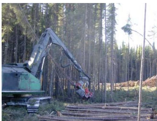
Figure 6. Façonnage multi-tiges avec une tête Logmax 7000, non conçue pour le multi-tiges.
