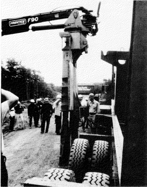
Figure 2. La chargeuse séparée de la remorque.
