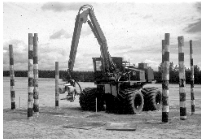
Figure 1. Essai du porteur expérimental dans la «forêt artificielle».
