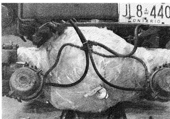
Figure 3. Phase I: isolant avec papier coupe-vapeur recouvrant entièrement l'essieu.
