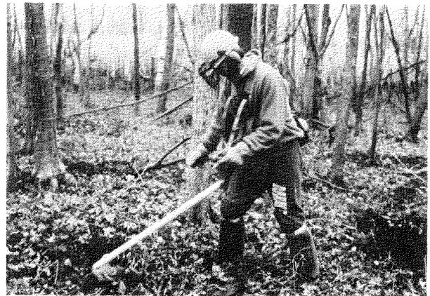
Figure 1. Le scarificateur semi-motorisé "La Taupe".
