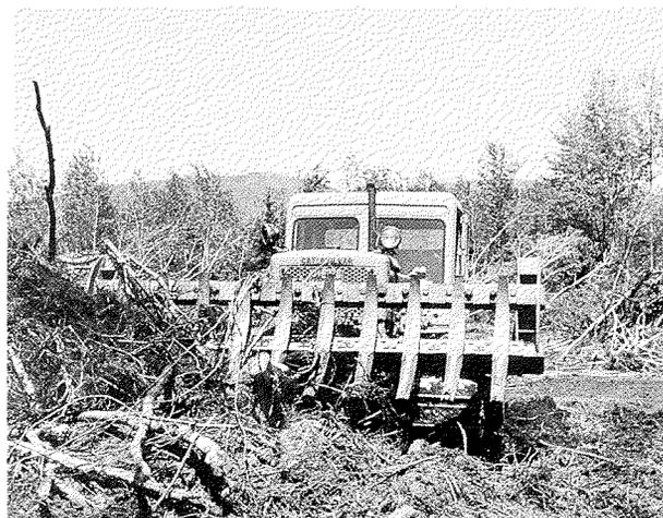
Figure 1. Boteur muni d'un râteau défricheur datant des années 1950.
