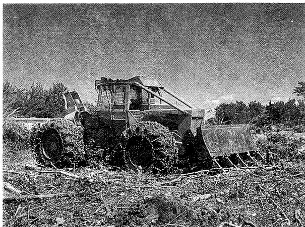
Figure 2. Débardeur à câble muni d'un râteau sylvicole à dents rétractables.
