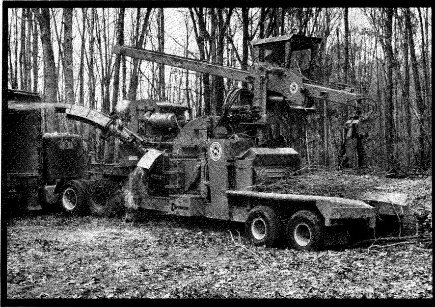
Fig. 8 Le Chiparvestor, modèle 22 (1977), fixé à un tracteur, procède au chargement d'une remorque à copeaux. L'engin est muni d'une flèche d'alimentation coulissante et d'un éliminateur de déchets (goulotte à déchets). — Photo de Canadian Morbark Ltée.
