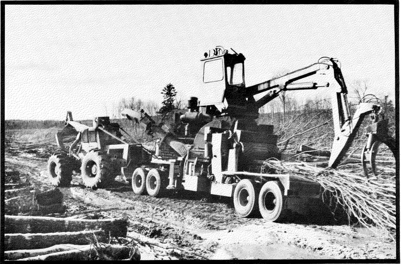
Fig. 5 A la Compagnie B, on utilisait pour déplacer le Chiparvestor un chariot d'accouplement fixé à un débardeur.
