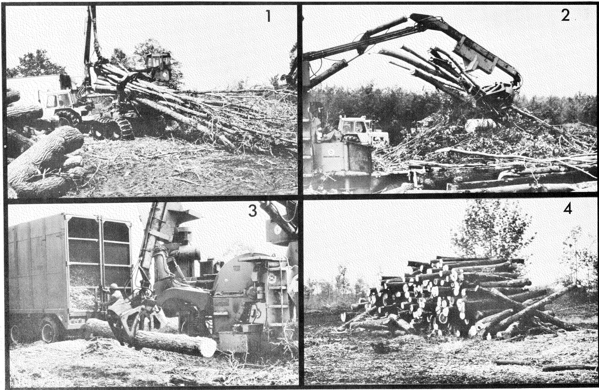
Fig. 3 Séquence des opérations à la Compagnie A: (1) débardage d'arbres entiers à l'aide du Volvo SM-868, (2) le Chiparvestor chargeant d'arbres entiers le convoyeur d'alimentation, (3), (4) les billes de sciage séparées et empilées le long de la jetée.
