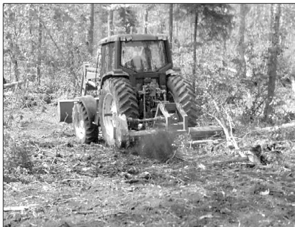
Figure 2. Broyage à l'aide du Meri MJ-2.3 monté sur un tracteur John Deere 6400.
