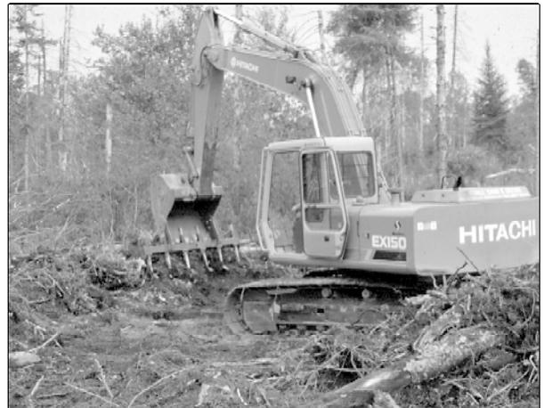
Figure 5. Décapage à l'aide d'un râteau artisanal monté sur une excavatrice Hitachi EX150.
