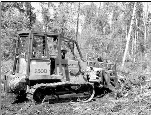
Figure 4. Décapage à l'aide d'un râteau artisanal monté sur un boteur Case 850D.
