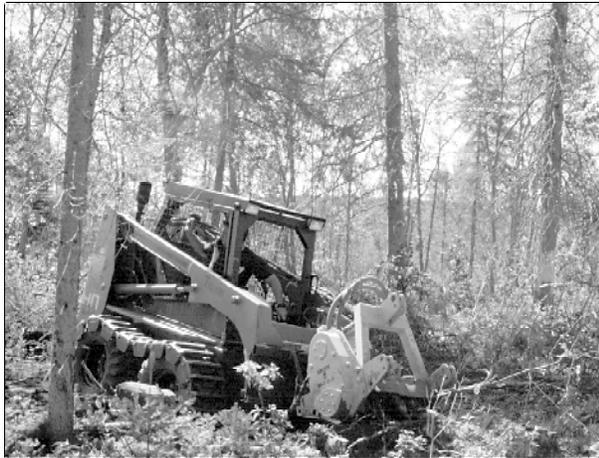
Figure 3. Broyage avec le Meri MJ-0.8 monté sur une chargeuse à chenilles Thomas HD233.
