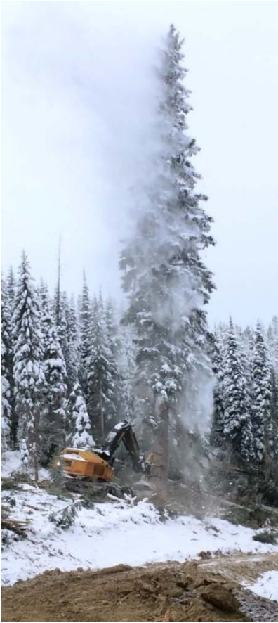
Figure 1. Abatteuse-groupeuse Tigercat 870C2 2011 coupant une grande épinette.
