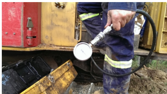
Figure 2. Manomètre hydraulique utilisé pour le réglage de la marge de pression et la vérification du fonctionnement des soupapes de décharge.
