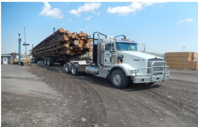
**Figure 3. Configuration typique des camions de transport de Spray Lake.**
