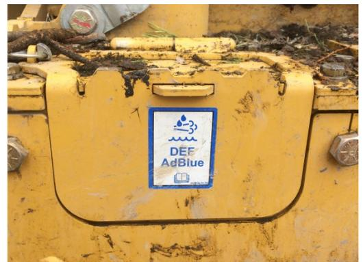
Figure 1. Point de remplissage du FED, situé sous le marchepied de la débardeuse Tigercat 630E.
