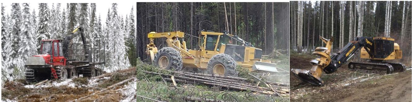
Figure 2. De gauche à droite : Transporteur Komatsu 895, débardeuse à grappin Tigercat 630E et abatteuse-groupeuse 845D mis à l'essai.
