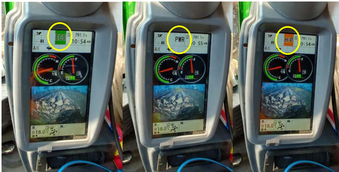
Figure 1. Modes d'utilisation sélectionnés par l'utilisateur dans cette machine John Deere : ECO (économie), PWR (puissance) et H/P (haute performance).
