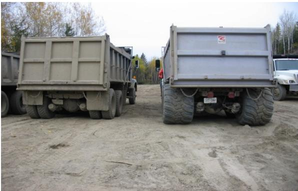
**Figure 2. L'utilisation de systèmes de surveillance de la pression des pneus (SSPP) et de pneus larges peut prolonger la vie utile des routes et réduire les impacts sur la surface.**
