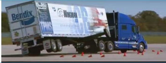
a) Camion non équipé d'un système d'ESC
