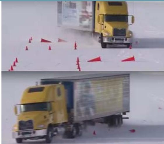
a) Camion non équipé d'un système d'ESC
