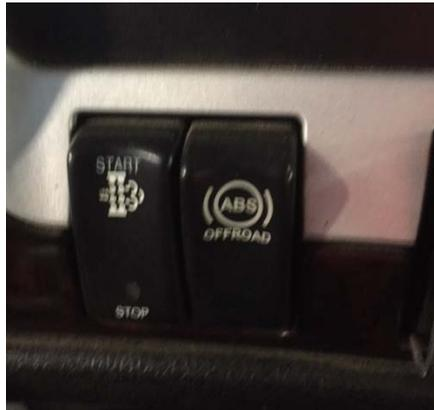
Figure 15. Interrupteur ABS hors route.
