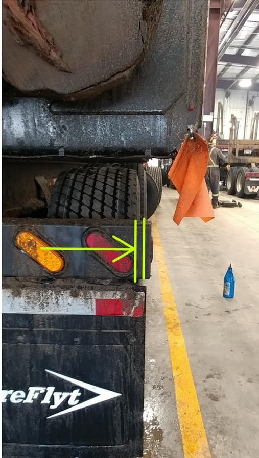
Figure 5. Différence entre le flanc externe et le pneu jumelé à l'arrière-plan
