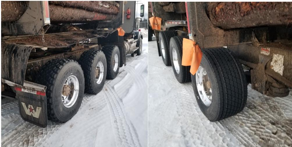
Figure 2. Pneus à bande large - essieux moteurs (à gauche) et essieux de remorque (à droite)
