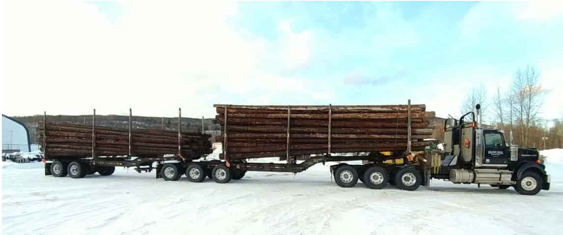
Figure 1. Véhicule d'essai équipé de pneus à bande large sur les essieux moteurs et de la remorque
