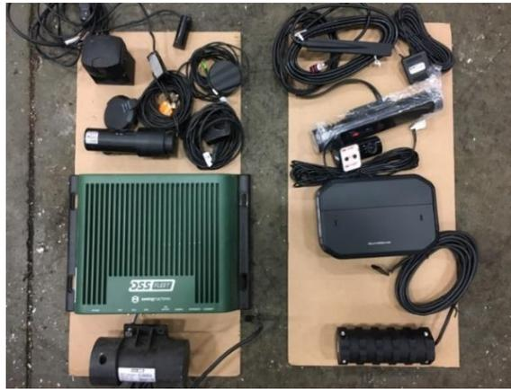
**Figure 1.** Première génération (à gauche) et de deuxième génération (à droite) de la technologie Guardian de Seeing Machines
