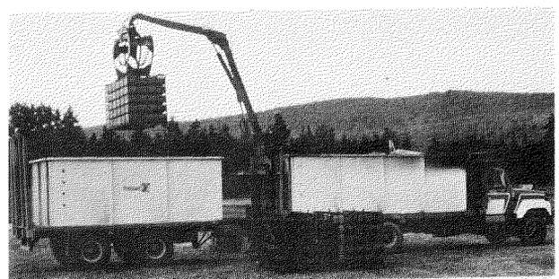
Figure 6. Étude 2 (deuxième partie): le chargement et le déchargement du cadre de transport sont effectués par une grue montée sur le camion.
