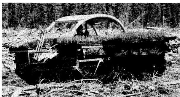
Figure 12. Véhicule à chenilles servant au transport des semis hors-route.
