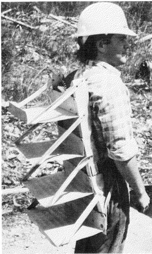
Figure 17. Support à dos pour caissettes multipots.
