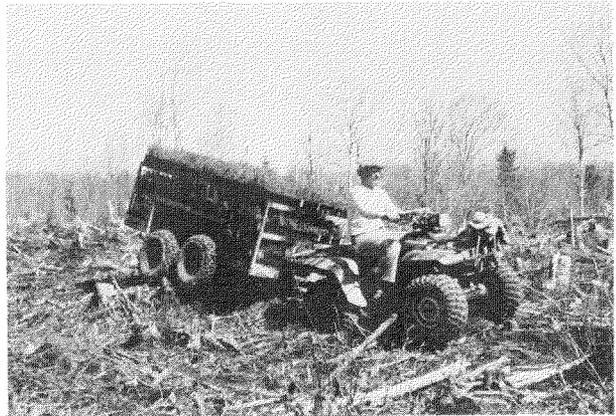
Figure 19. Remorque à semis dotée d'un système de pont tandem et d'un balancier.
