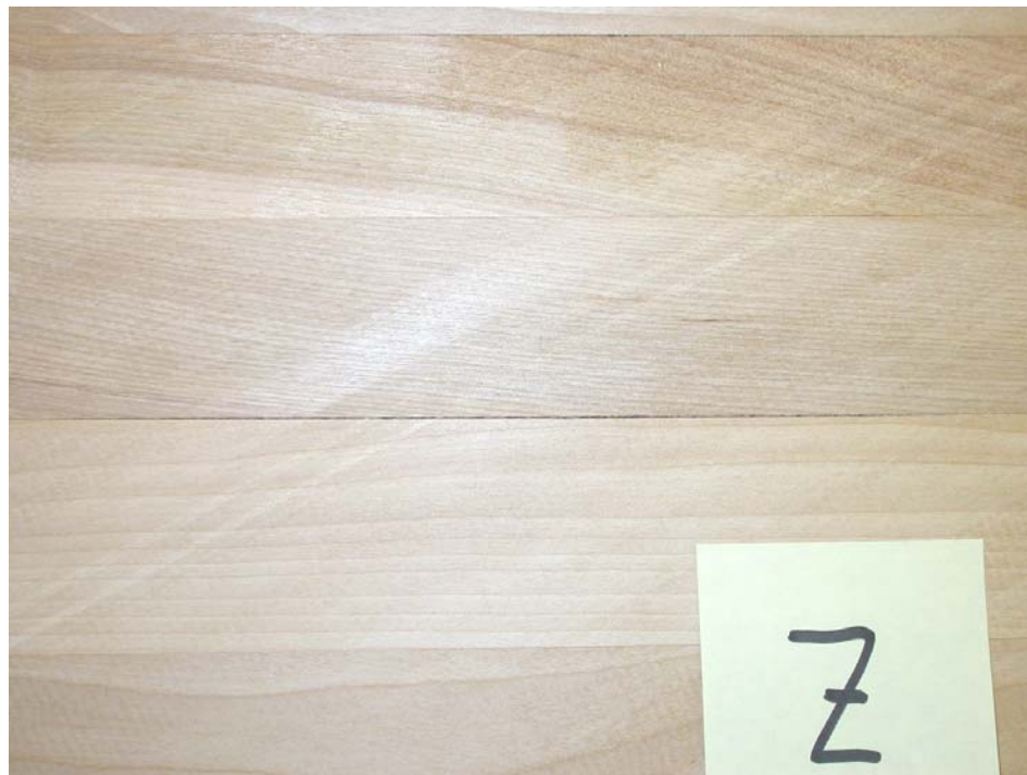
Figure 7 Joint apparent : rectitude du trait de scie, largeur max. de l'ouverture de 0.79 mm.
