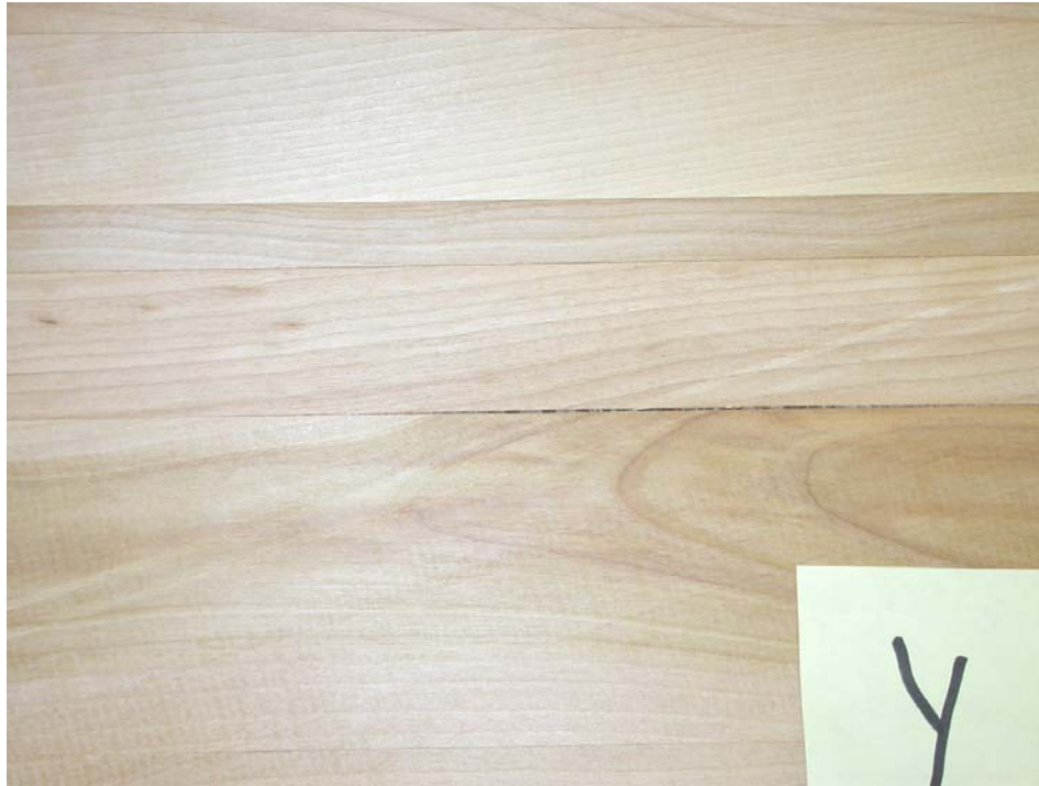
Figure 6 Joint apparent : rectitude du trait de scie, largeur max. de l'ouverture de 0.82 mm.
