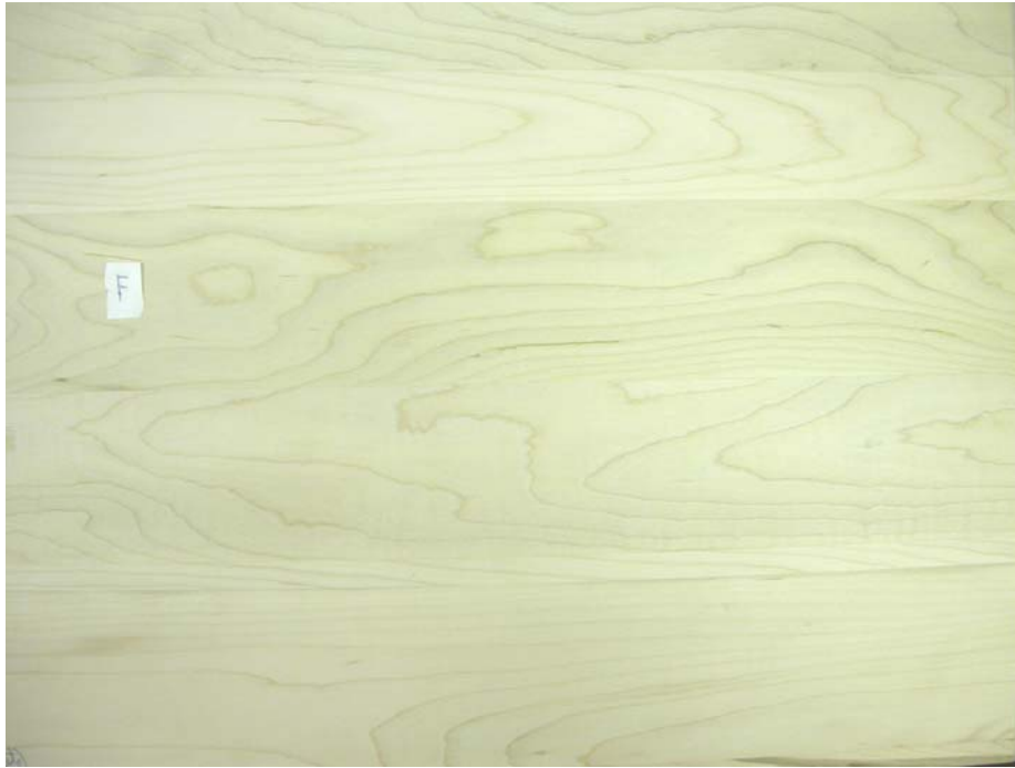
Figure 4 Joints apparents : trop grande rugosité du bois sur chant ou trop faible pression aux serres, largeur des joints variant de 0.07 à 0.15 mm.
