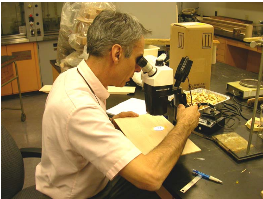
Figure 1 Mesure de la largeur des joints de colle au microscope
