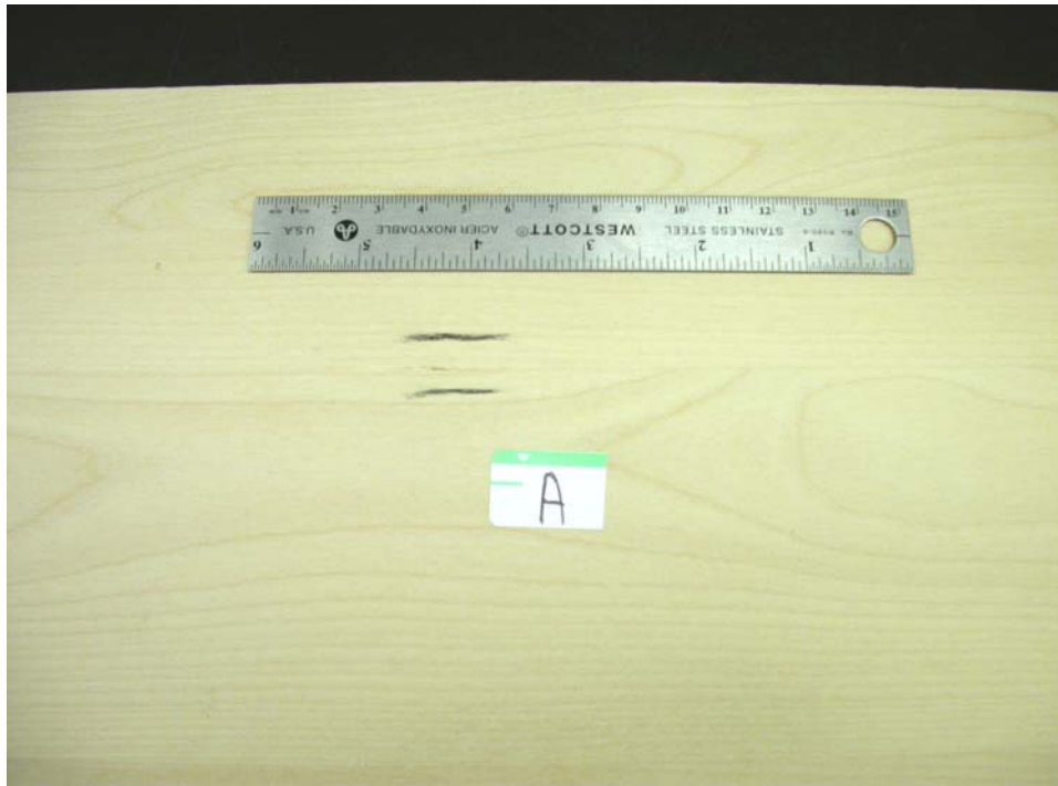
Figure 2 Joint apparent : éclatement des fibres sur l'arête, largeur de la cavité de 0.6 mm.
