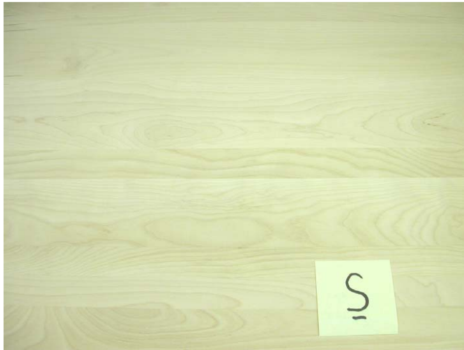
Figure 5 Joints apparents : trop grande rugosité du bois sur chant ou trop faible pression aux serres, largeur mesurée des joints de 0.08 mm.
