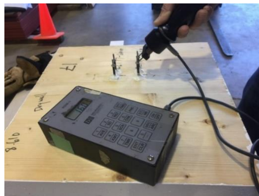
Figure 2. Mesure de la teneur en humidité à l'aide d'un humidimètre portatif (haut) et d'aiguilles préinstallées (bas)
