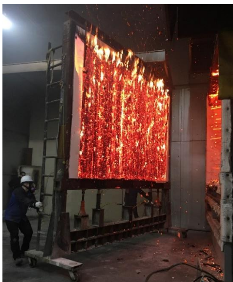
Figure 3. Fin d'un test de résistance au feu d'un mur en DLT
