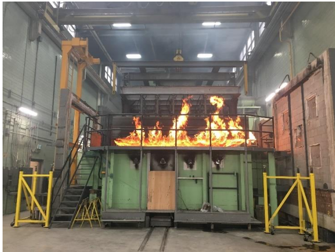
Figure 1. Enlèvement d'un plancher en GLT après un essai de résistance au feu effectué par FPInnovations au Conseil national de recherches du Canada
