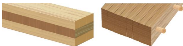
Figure 2. Trois générations de produits de plancher en bois : solives en bois de charpente (A), solives en bois d'ingénierie (B) et dalles en bois massif (C).
